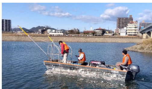
魚を感電させる「電気ショッカーボート」を使った駆除も実施
